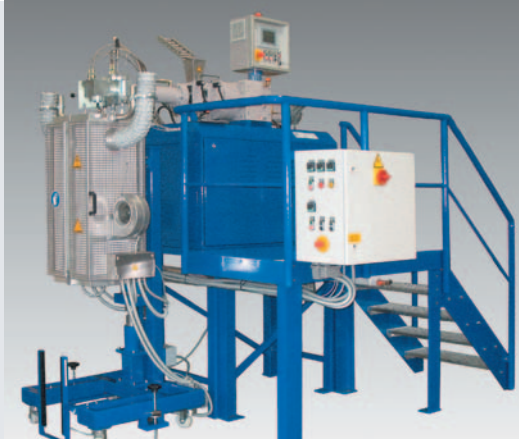
Línea de extrusión para siliconas
