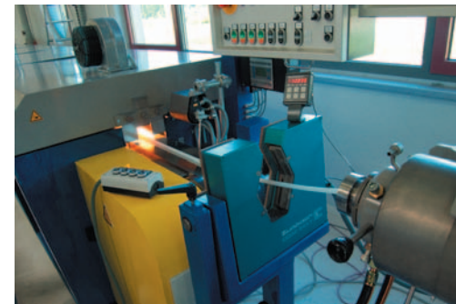
Габариты изделия контролируются с помощью интегрированной в систему управления двухосевой лазерной головки. Благодаря этому производятся изделия с высокой точностью размеров.
