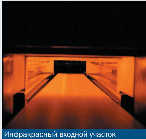
Автоматическая система направления ленты на входе служит для безупречно ровного ведения ленты из мелкоячеистой стальной сетки.
