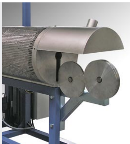
Unidad de redireccionamiento en la entrada
