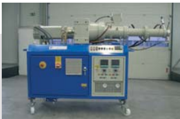
EEK 45.14 S pour la fabrication des tuyaux
