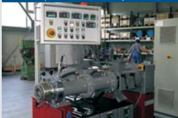
EEK 63.14 pour la transformation du fluor caoutchouc
