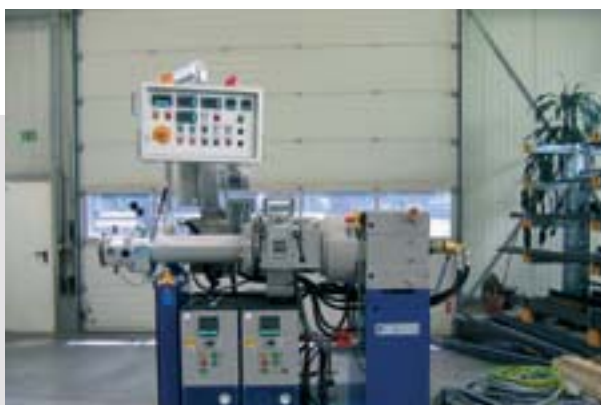
EEK 63.10 S pour la transformation du caoutchouc
