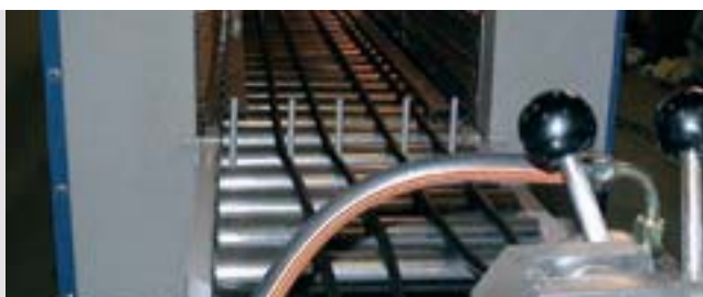
Туннель с горячим воздухом для изоляционных рукавов
