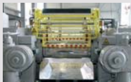
Механическая регулировка зазора между вальцами
