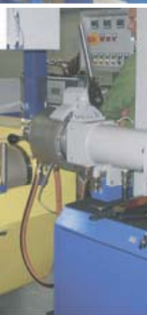
LCM 20 RS/EL установка вулканизации в расплаве солей
