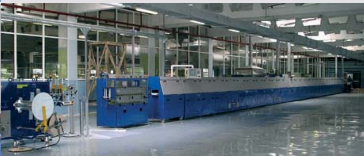
LCM 20 RS/EL установка вулканизации в расплаве солей
