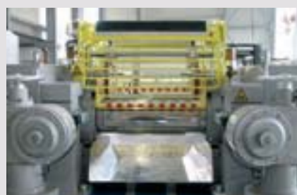
Réglage de la distance entre les cylindres motorisés
