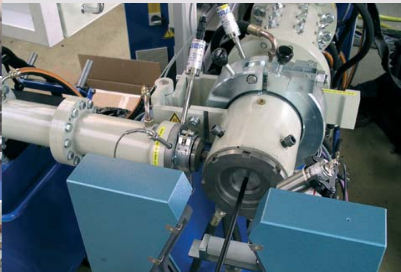
Installation des extrudeuses pour la fabrication des tuyaux de carburant
