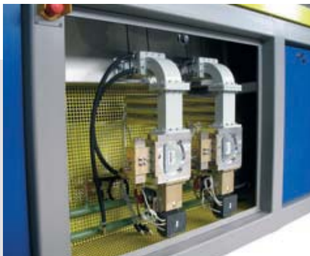
Extrusora junto con túnel de vulcanización microondas
