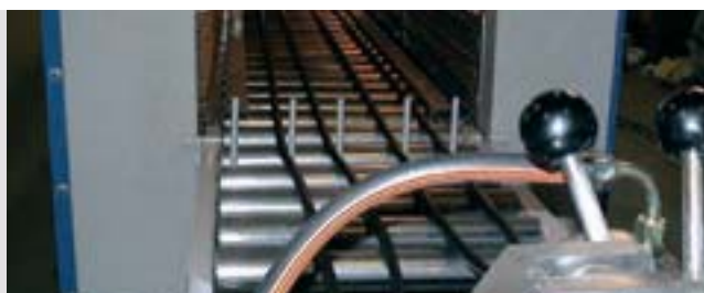
Túnel por aire caliente en operación
